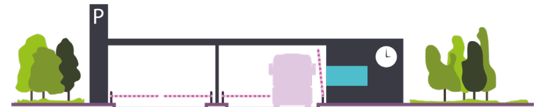
acceso doble controlado con barrera
