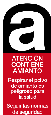
Fig. 4. Etiqueta reglamentaria de identificación de materiales con amianto.
